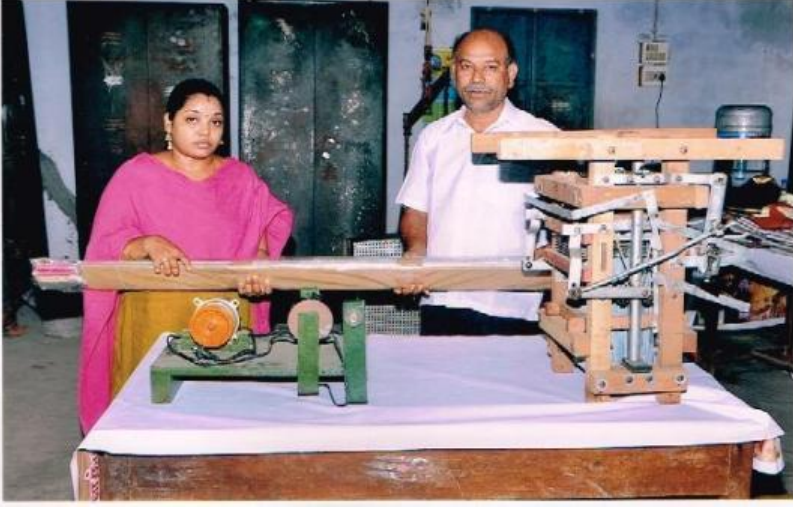
புளரமைக்கப்பட்ட அச்சு, விழுது, நாடா, ஜக்கார்ட் பெட்டி மற்றும் தார் சுற்றும் இயந்திரத் தொகுதி - சும்பகோணம்
